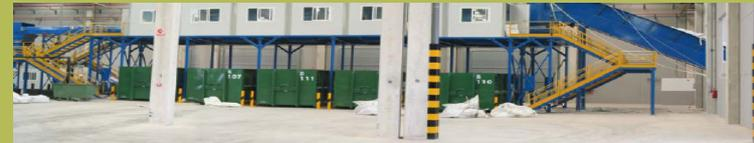
La plataforma dispone de 2 zonas de selección manual y en cada una de ellas pueden colocarse hasta 4 operarios por línea, resultando 16 puestos de selección en total. Estos puestos de trabajo están dispuestos de manera que los productos seleccionados puedan ser lanzados por gravedad a través de unas tolvas montadas al efecto, hacia los contenedores abiertos situados bajo la plataforma.
