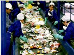
Estos puestos de trabajo están dispuestos de manera que los productos seleccionados puedan ser lanzados por gravedad a través de unas tolvas montadas al efecto, hacia las cintas-silo de almacenamiento situadas bajo la plataforma.
