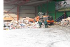
Una vez realizada la descarga, un operario con una pala cargadora realiza una inspección visual y retira todos aquellos residuos que por su gran tamaño u otras características no deban ser introducidos en la línea de clasificación.
